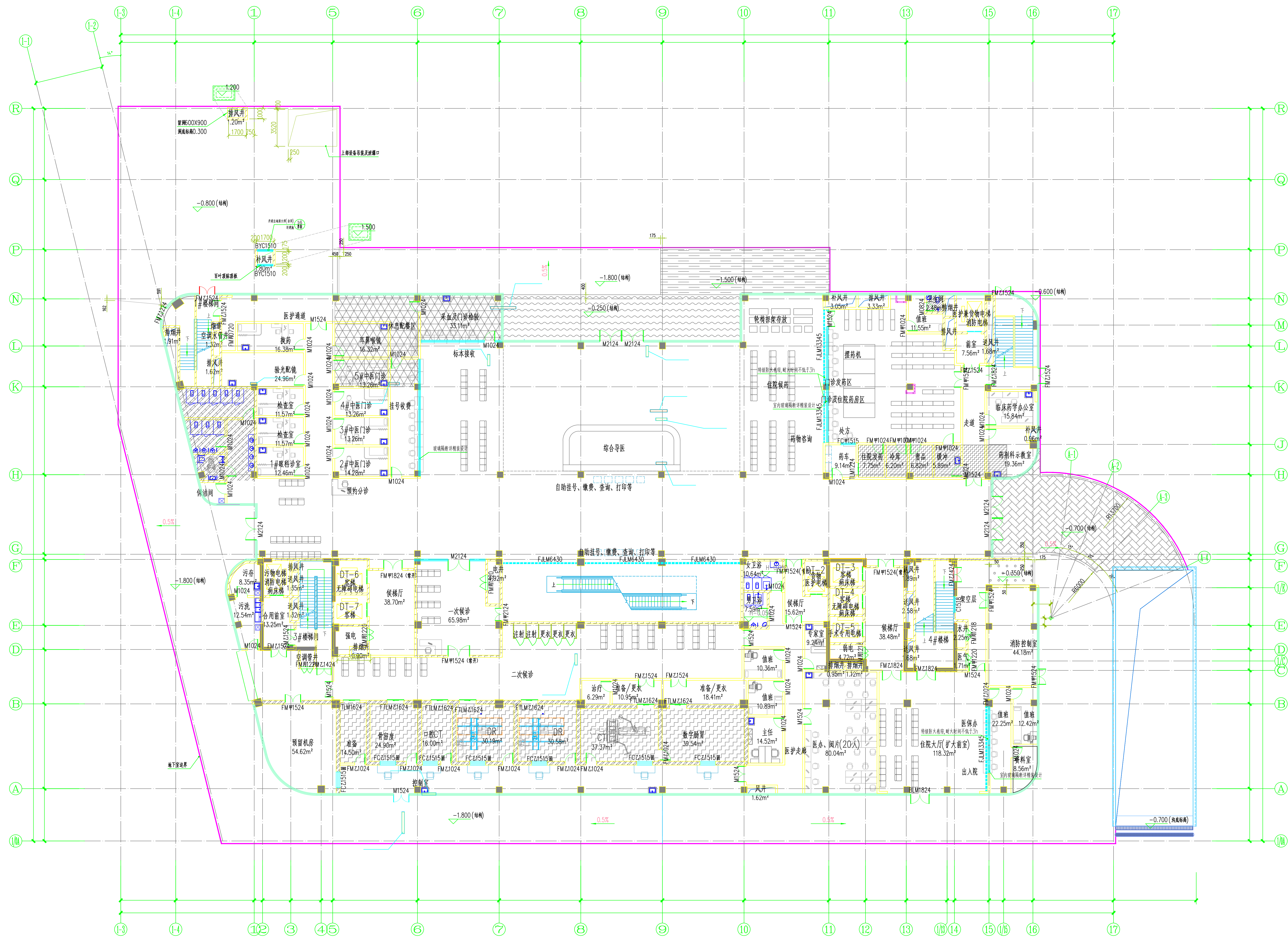
地下室顶板平面图 1:150
